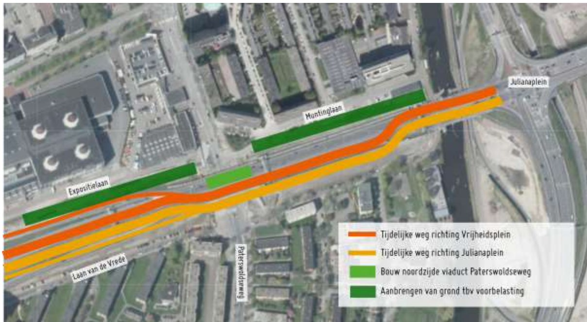
Afbeelding: Werkzaamheden rondom Paterswoldseweg
