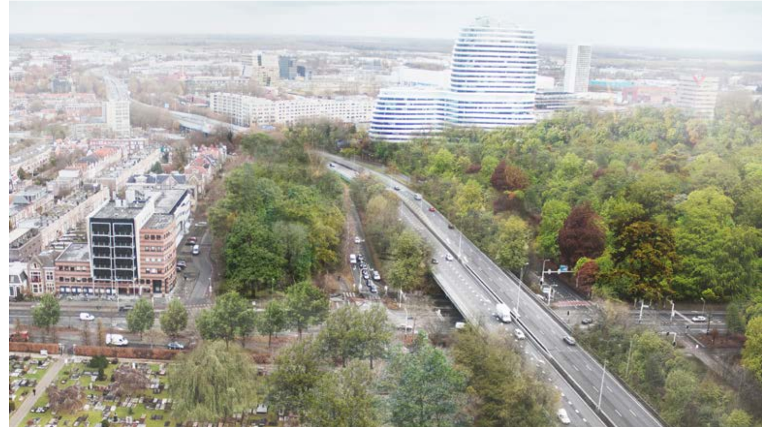
DE ZUIDLIJKE RINGWEG SPLITST DE WIJKEN VAN GRONINGEN ZUID IN TWEEËN. LINKS ZIET U DE HEREWEGBUURT MET DE ZUIDERBEGRAAFPLAATS EN RECHTS HET STERREBOS. BIJ DE OMBOUW VAN DE RINGWEG VERDWIJNT EEN GROOT DEEL VAN DE WEG ONDER ZOGENAAMDE 'DEKSELS'. DOOR DIE DEKSELS KAN HET STERREBOS WEER IN ERE WORDEN HERSTELD.
