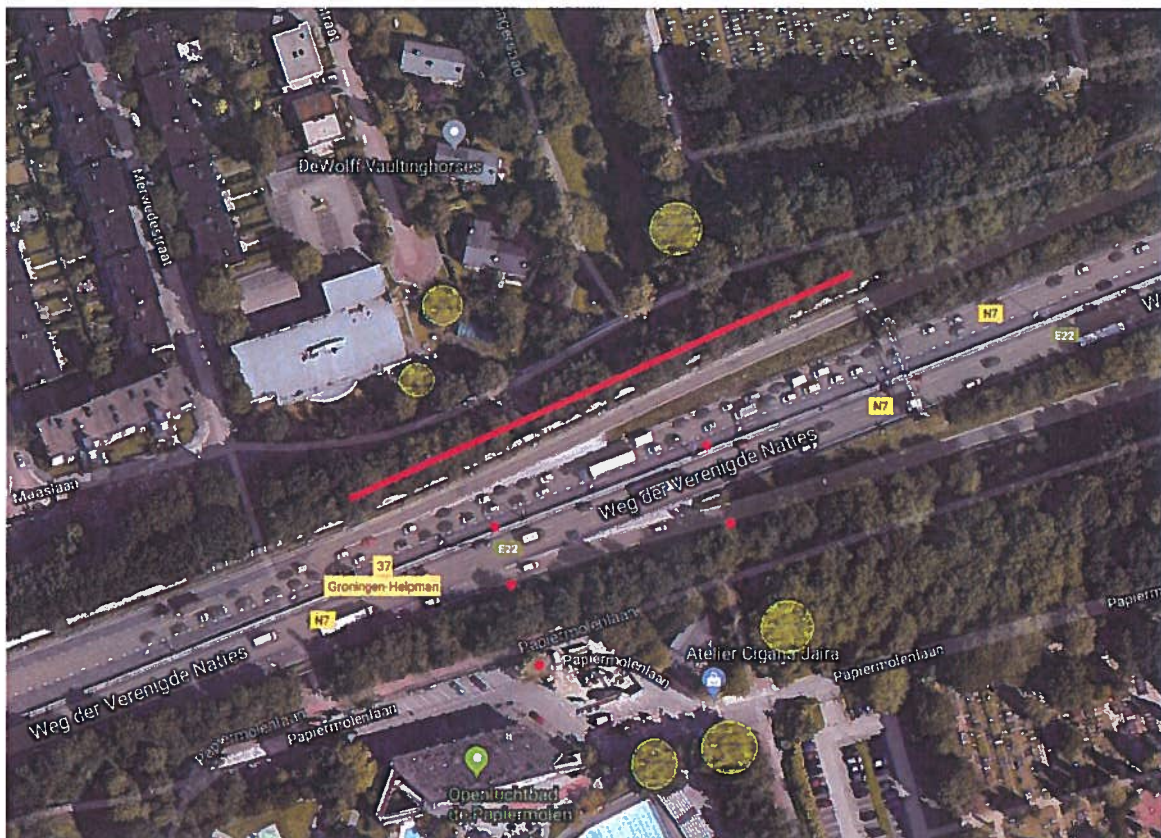
Afbeelding 4-3 Locatie van de tijdelijke hop-overs bij de Lekstraak en de Dinkelvijver. Met een rode lijn is aangegeven over welke lengte (circa 150 m) het geluidsscherm verhoogd wordt tot 4 meter. Met rode stippen zijn de locaties van de bakens aangegeven. Elke stip representeert daarbij een paal met daarop een scherm van 1m 2 waarbij de onderkant van het scherm zich op een hoogte van 4 meter bevindt. De doorzichtige groene vlekken geven relatief hoge bomen aan die behouden zullen blijven en kunnen dienen als geleiding naar de tijdelijke hop-overs.
